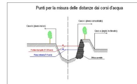
Figura 1 - Sezione tipo di alveo fluviale con individuazione dei punti per la misura delle distanze
